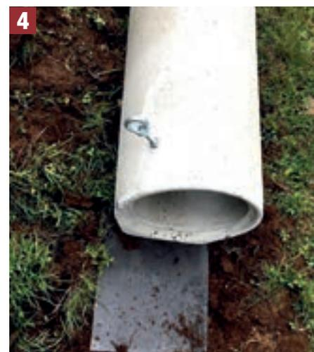
An den Enden, an welchen die Fallbleche hinkommen, sollte man eine Platte oder Blech unterlegen. Dies verhindert, dass sich die Fallbleche nach vielen Auslösungen in den Boden graben und das Rohr nicht mehr sauber verschlossen wird.
