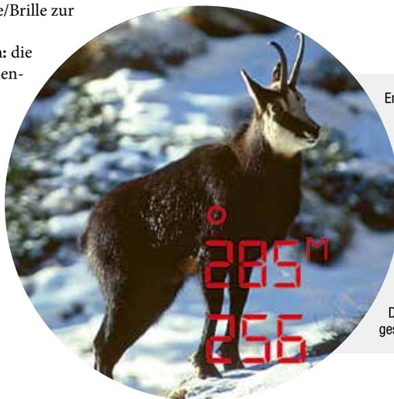
Entfernungs- und Winkelmesser sorgen dafür, dass bei einem Schuss nach oben oder unten die richtige Distanz eingestellt wird.
