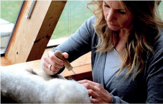
Der Prozess des Filzens ist aufwendig und verlangt Genauigkeit. Bevor mit heißer Seifenlauge nass gefilzt werden kann, bereitet Marlene Partl die Tiroler Schafwolle mit einer Filznadel auf die Form vor, die diese nachher annehmen soll.
