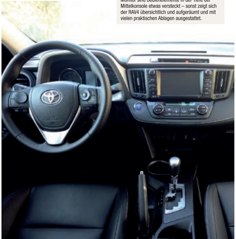
**Sieben-Zoll-Touch-Display, Rückfahrkamera und Bluetooth-Freisprechsystem:** Unter dem Monitor sind Bedienelemente in der Tiefe der Mittelkonsole etwas versteckt – sonst zeigt sich der RAV4 übersichtlich und aufgeräumt und mit vielen praktischen Ablagen ausgestattet.
