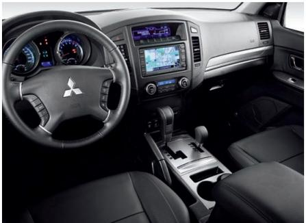
Das Cockpit mit Kompass und Höhenmesser in der Mittelkonsole ist klar strukturiert. Der Allrad-Antrieb wird über den Wahlhebel in der Mittelkonsole gesteuert.
