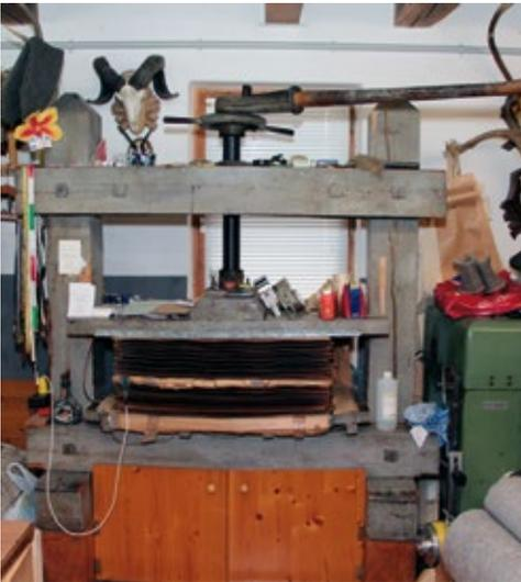
Quergewebe mit dem Schuss – nach dem Weben wird der Lodenstoff gewalkt (Bild oben links). Sowohl David als auch Rosmarie Kreutner können sämtliche Maschinen bedienen und reparieren. Die Stoffpresse (Bild links unten) stammt aus der 1. Generation und funktioniert nach wie vor tadellos.
